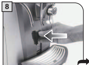
8 Die Halterung der Dampfdüse herausnehmen und reinigen. Danach wieder einsetzen.
